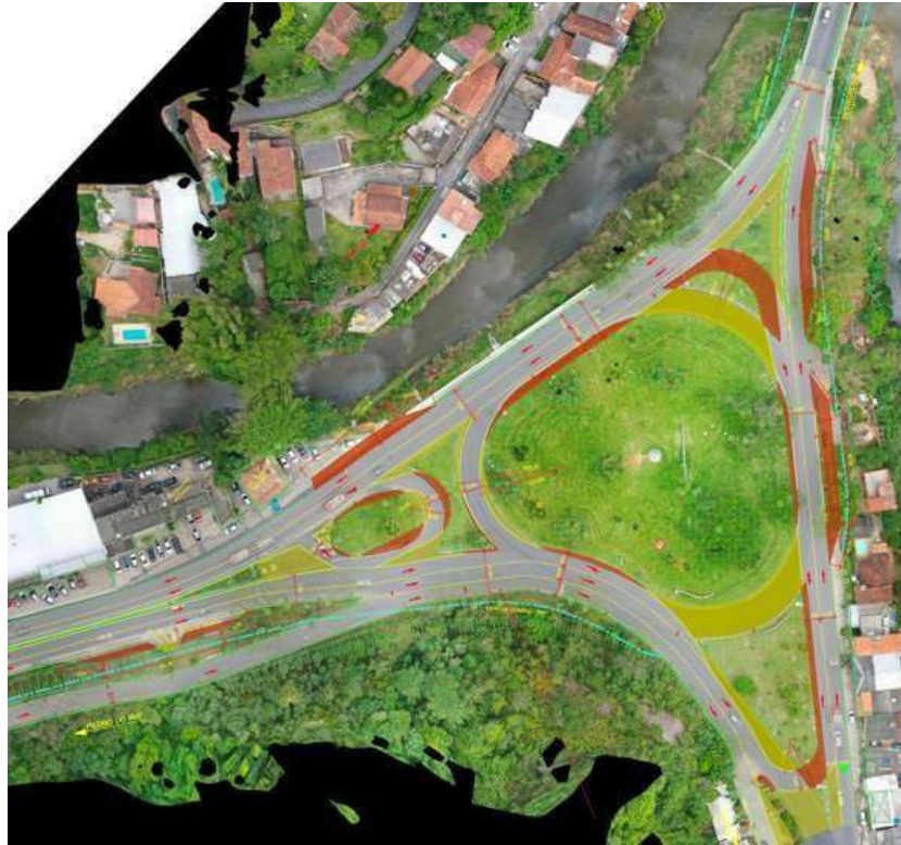
Figura 7: Proposta de Alteração de Geometria no Trevo de Bonsucesso
