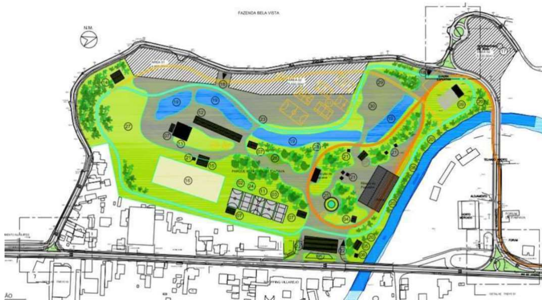
Figura 8: Projeto de alterações no Horto mercado, incluindo criação de nova ponte sobre o rio.
