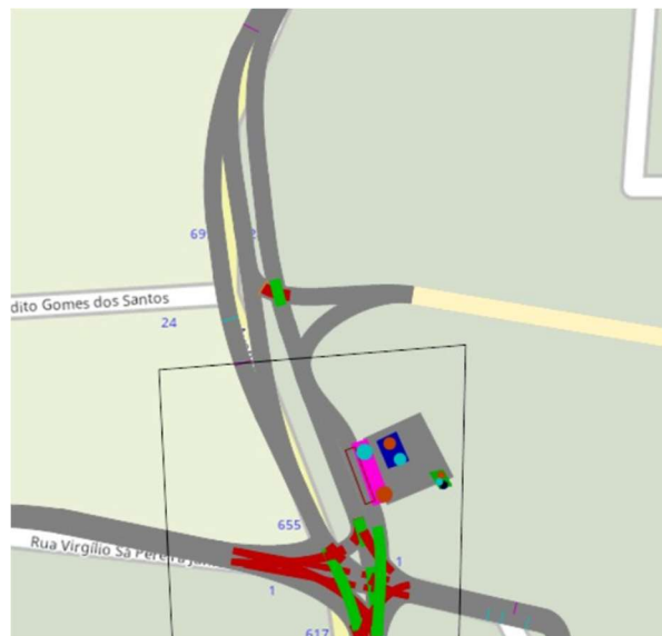
Figura 16: Possibilidade de Interseção da Nova Ponte com a Estrada União e Indústria (Cenário 2 - PTV Vissim)
