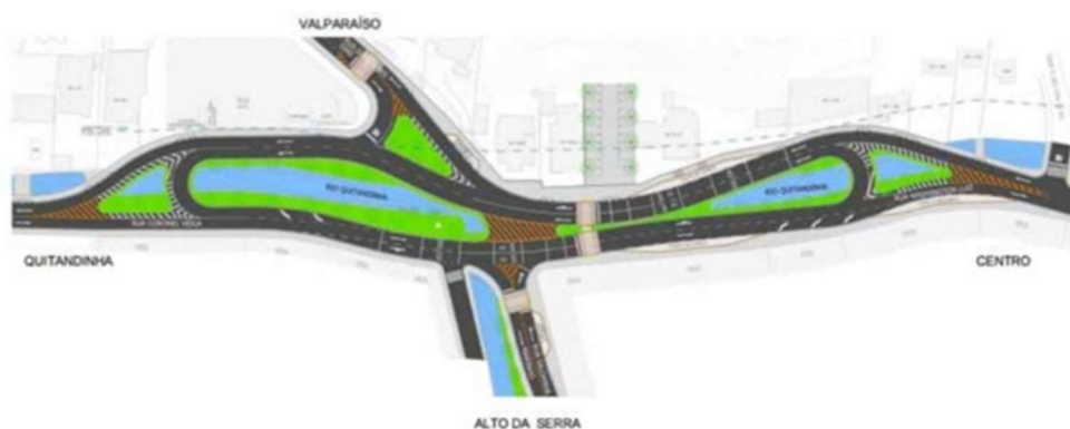
Figura 5: Projeto de Alteração da Geometria na Interseção Atual – PlanMob 2019
